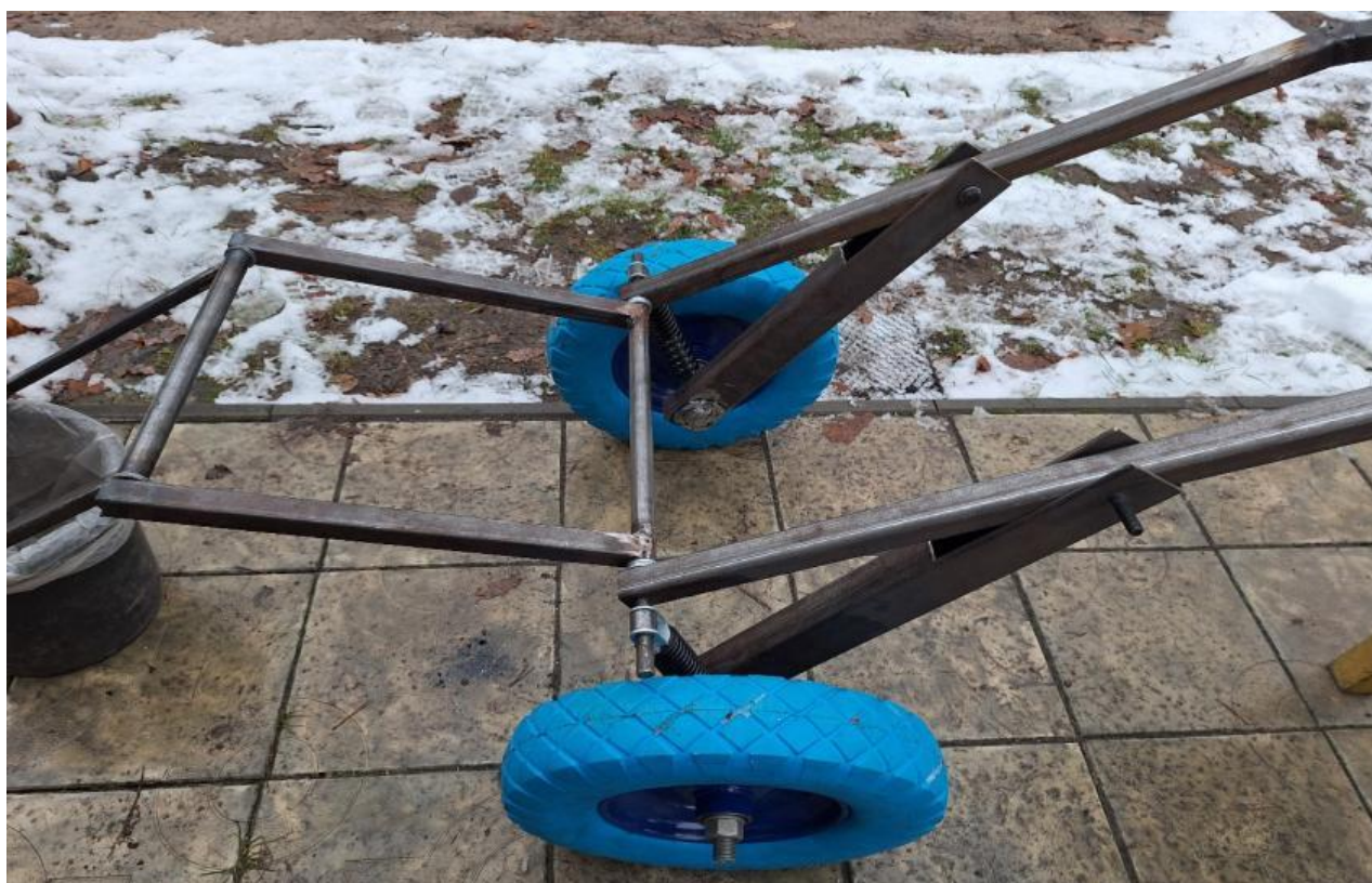
Рисунок 19. Встановлення коліс на важелі незалежної підвіски. Кріплення важелів до основної рами.
