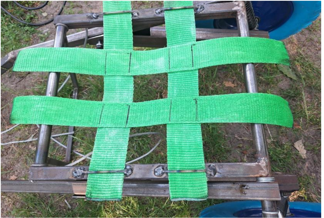
Рисунок 23. Пошив та встановлення строп на основній рамі та вантажних площадок.
