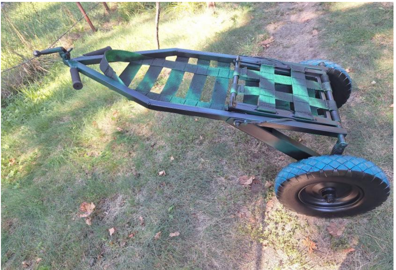
Рисунок 26. Загальний вид візочка у складеному (похідному) стані.
