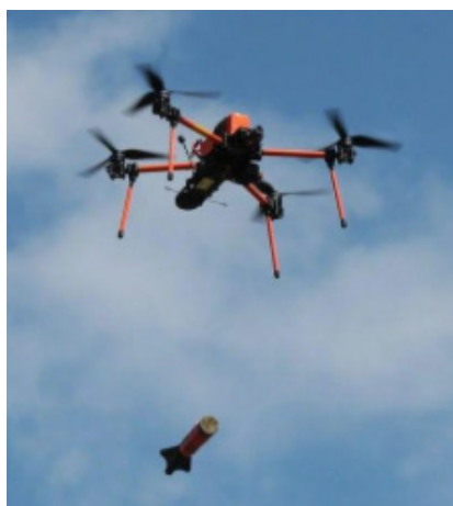
Рисунок 3.9 – Цивільний БпЛА скидає переобладнаний ВОГ
