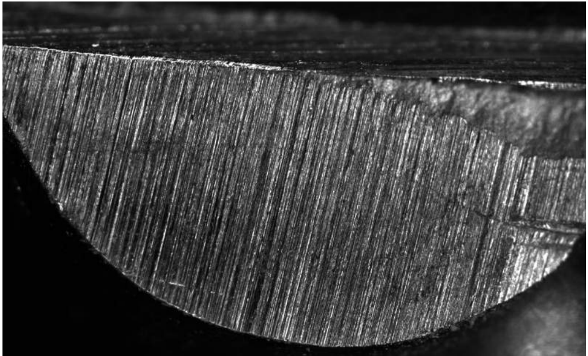
Сліди перекусу дужки навісного замка.
