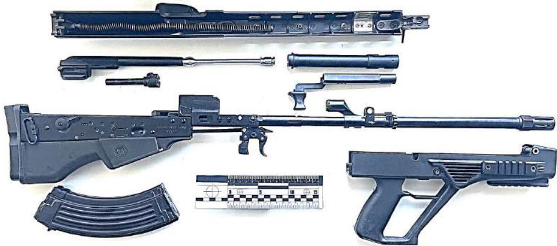
Вогнестрільна зброя компоновки bull-pup (неповне розбирання)
