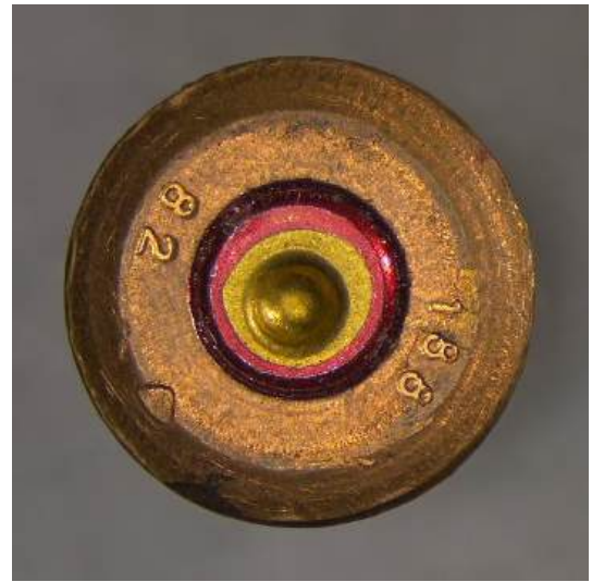
Слід бойка ударника на капсулі гільзи.
