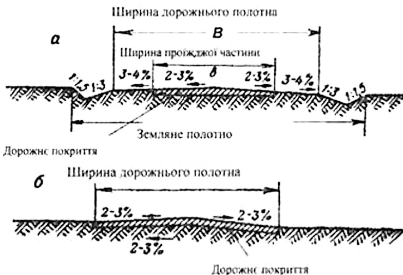
Рис. 7.2 – Поперечний профіль земляного полотна дороги в нульових відмітках: а – з кюветами; б – без кюветів
