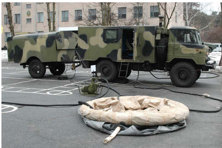
Рис. 8.9 – Військова фільтрувальна станція ВФС-2,5
