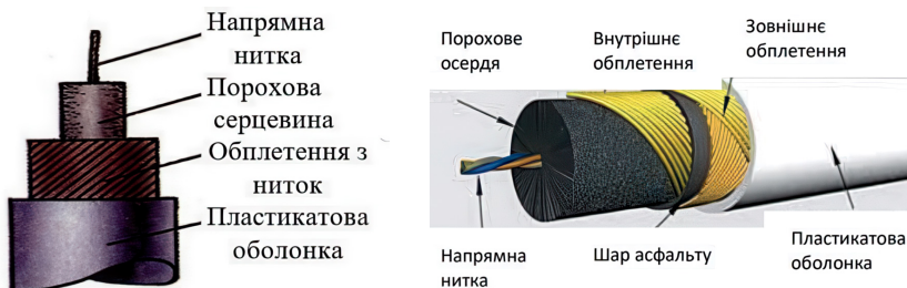
Рис. 4.14 – Будова вогнепровідного шнура
