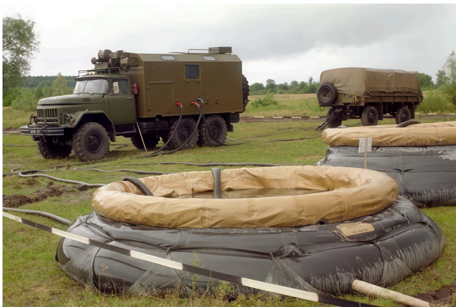
Рис. 8.11 – Військова фільтрувальна станція ВФС-10
