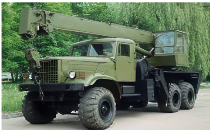
Рис. 1.4 – Загальний вигляд автомобільного крана КС-3572
