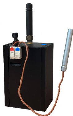
Рис. 4.35 – Виконавчий пристрій радіокерованої підривної машинки з системою оповіщення про розрив датчика цілі
