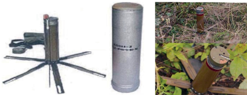
Рис. 5.32 – Міна ПОМ-3, встановлена в ґрунті
