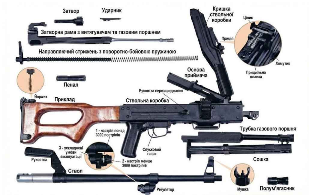
Рисунок 4.2 – Основні частини та механізми ПКМ (кулемет Калашнікова модернізований)
