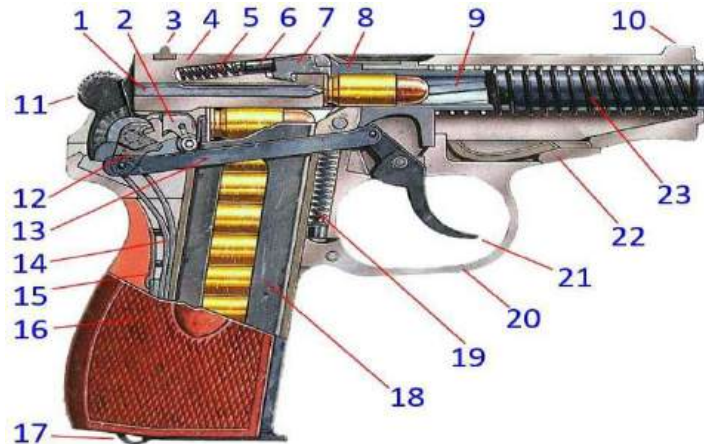
Рис. 5.20. 9 мм пістолет Макарова у розрізі:
