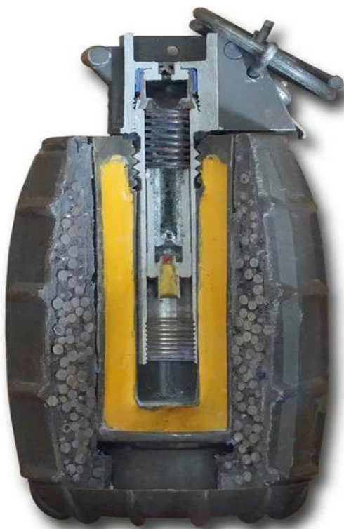
Рис. 7.16. Ручна граната DM51 в розрізі
