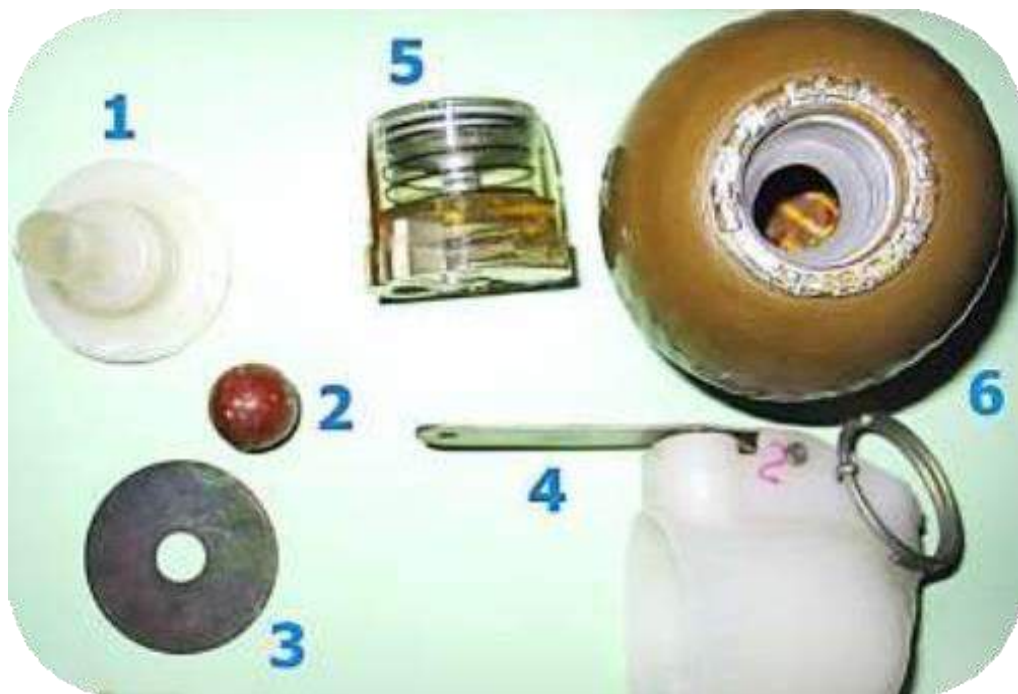
Рис. 7.14. Частини розібраного запалу УДЗ і корпус бойової частини гранати: 1 – трубка детонаційної шапки; 2 – інерційна кулька; 3 – мембрана; 4 – запобіжно-накольний механізм із спусковим важелем; 5 – ударний датчик; 6 – корпус гранати РГО
