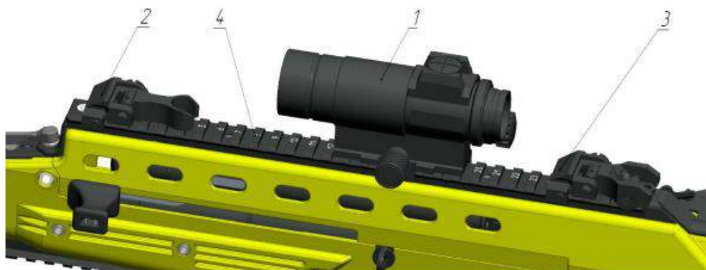
Рис. 6.93. Встановлення механічних і оптичних прицілів 1 – коліматорний приціл; 2 – механічна мушка; 3 – механічний приціл; 4 – верхня планка «пікатінні»
