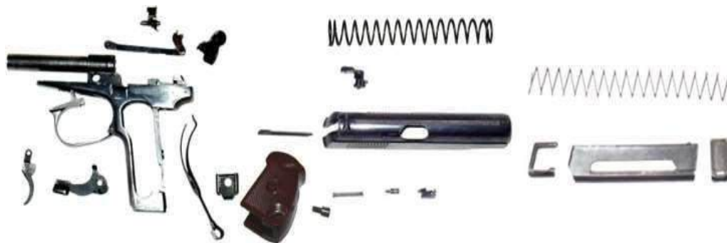
Рис. 5.22. Частини пістолета після повного розбирання
