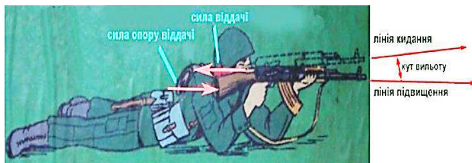
Рис. 2.3. Підкидання дульної частини ствола вгору при пострілі в результаті дії віддачі, утворення кута вильоту
