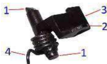
Рис. 5.13. Шептало з пружиною: 1 – цапфи шептала; 2 – зуб; 3 – носик шептала; 4 – пружина шептала
