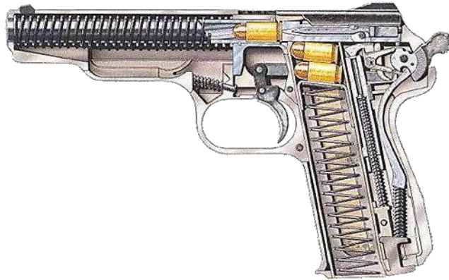
Рис. 5.30. Зібраний 9 мм пістолет Стечкина в розрізі
