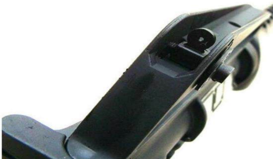
Рис. 6.58. Цілик перекидний, вид зверху
