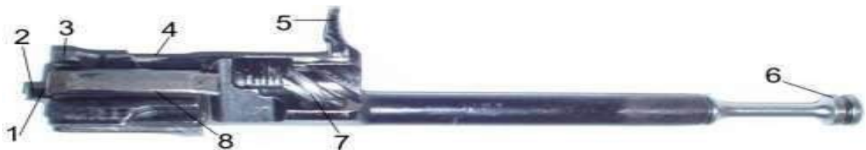
Рис. 6.18. Затворна рама з газовим поршнем:
