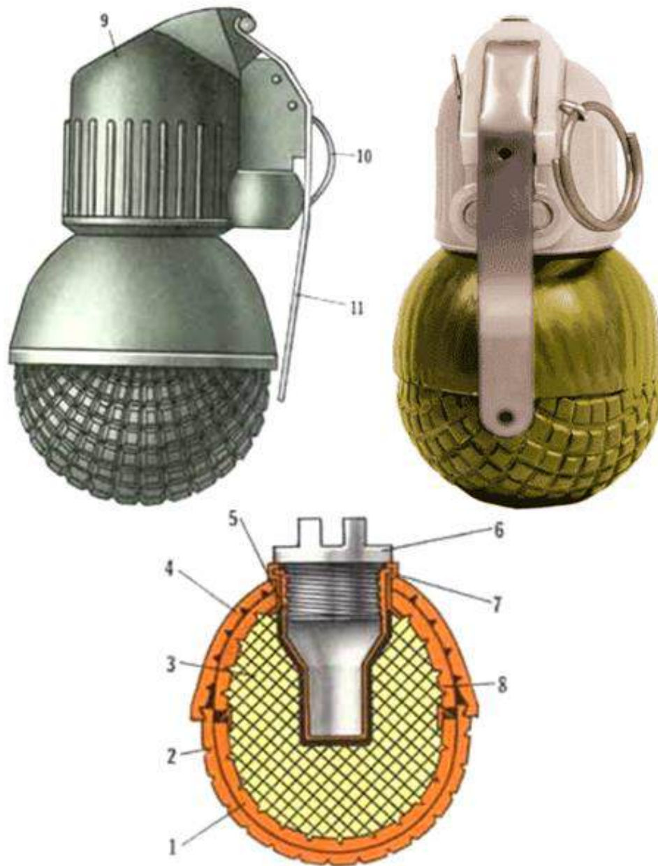
Рис. 7.8. Ручна осколкова граната РГО: 1 - нижня внутрішня півсфера; 2 - нижня зовнішня півсфера; 3 - вибухова суміш; 4 - верхня зовнішня півсфера; 5 - стакан; 6 - пробка; 7 - манжета; 8 - верхня внутрішня півсфера; 9 - ударно-дистанційний запал; 10 - кільце; 11 - важіль.
