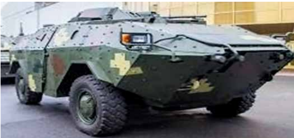
Рис. 2.3.3 – БРДМ2 обладнана додатковим захистом виготовленим з композитних матеріалів 5 класу захисту
