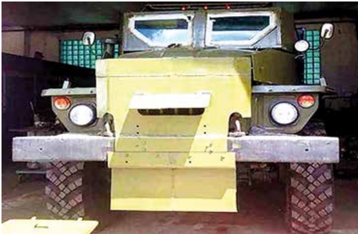
Рис. 2.3.2 – Вантажівка Урал з броньованим протикульним склом та встановлення захисту на моторне відділення
