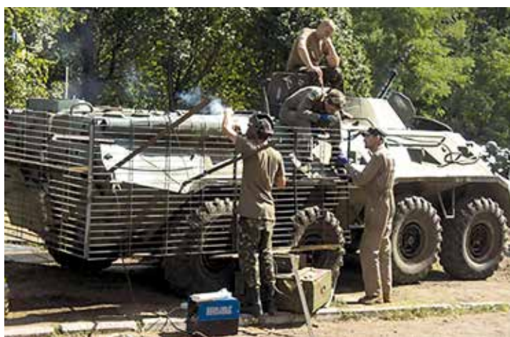
Рис. 2.3.1 – Встановлення протикумулятивних екранів на бойові машини
