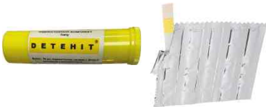
Рисунок 2.51 – Туба індикаторного комплекту типу DETENIT та алюмінієве пакування
