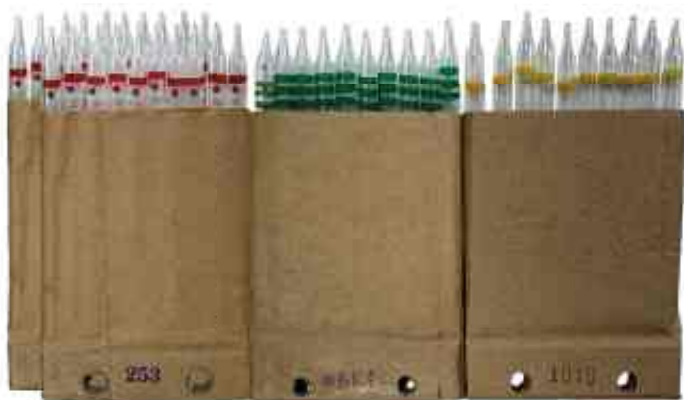
Рисунок 2.32 – Касети з індикаторними трубками
