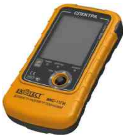
Рисунок 2.28 – Дозиметр-радіометр пошуковий МКС-11 «СПЕКТРА»
