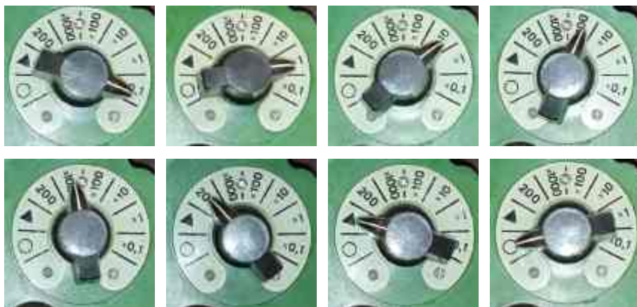
Рисунок 2.16 – Перемикач піддіапазонів у різних положеннях
