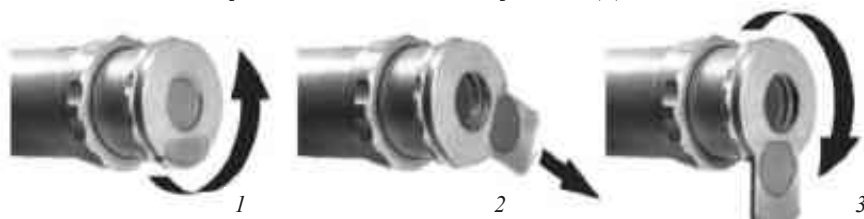
Рисунок 2.22 – Відкриття вікна бета-детектора БДКС-1: 1 – відпустити гайку, що фіксує шторку вікна бета-детектора; 2 – відкрити вікно бета-детектора; 3 – зафіксувати шторку вікна бета-детектора у відкритому стані
