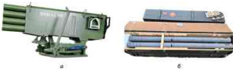
Рисунок 1.109 – Мала реактивна вогнеметна система «SIVALKA VM-8» та боєприпаси до неї: а – пускова установка; б – некеровані ракети С-8Тер у транспортному контейнері
