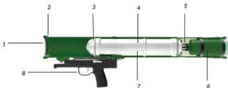
Рисунок 1.104 – Реактивний піхотний вогнемет РПВ-16: 1 – місце розгону боєприпасу; 2 – одноразовий транспортно-пусковий контейнер; 3 – обтікач бойової частини; 4 – корпус бойової частини; 5 – стабілізатор бойової частини; 6 – пороховий реактивний двигун, який кріпиться до ТБЧ у хвостовій частині та відпадає після пострілу; 7 – бойова термобарична частина ТБЧ; 8 – пусковий пристрій
