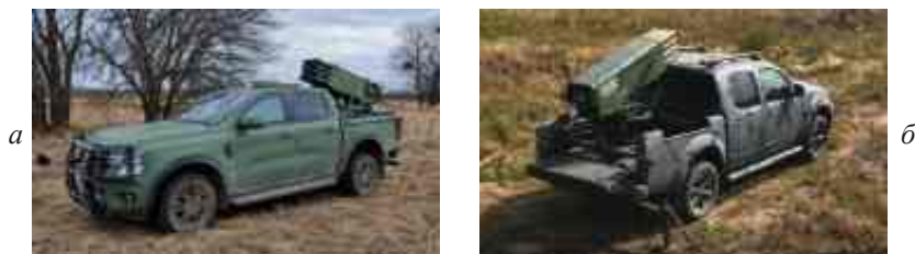
Рисунок 1.110 – Мала реактивна вогнеметна система «SIVALKA VM-8»: а – загальний вигляд системи на автомобільному шасі; б – вигляд пускової установки у бойовому положенні
