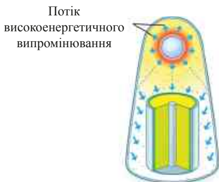
Рисунок 1.34 – Двоступенєва термоядерна схема, частина 2.
