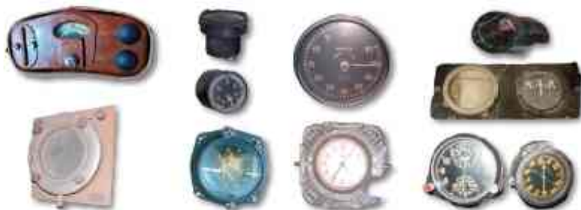
Рисунок 1.52 – Технічні вироби з можливою радіаційною небезпекою, виявлені у випадках незаконного обігу радіоактивних матеріалів у 2015–2025 рр.
