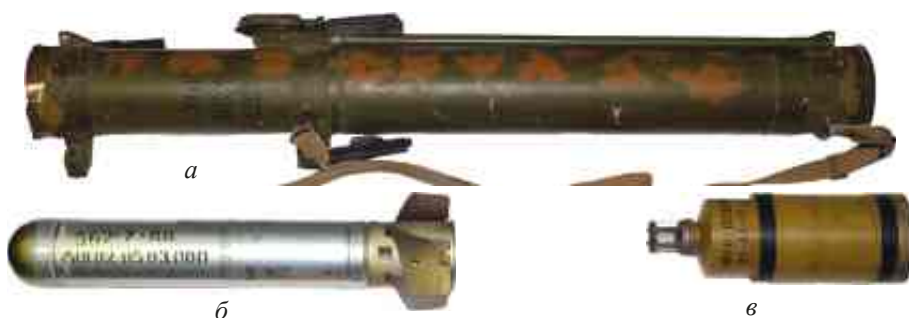
Рисунок 1.97 – Реактивний піхотний вогнемет РПО-А «Джміль»: а – зовнішній вигляд; б – боєприпас; в – двигун
