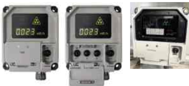
Рисунок 2.24 – Прилад радіаційної розвідки ДРГ-Т
