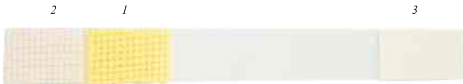
Рисунок 2.52 – Детекторна смужка типу DETENIT: 1 – жовтий еталонний шар; 2 – білий детекторний шар; 3 – білий індикаторний шар
