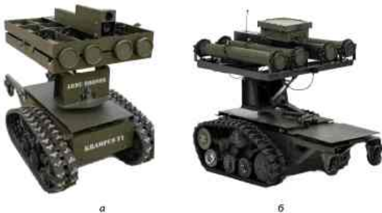
Рисунок 1.108 – Мобільний вогнететний ударний комплекс «KRAMPUS»:
