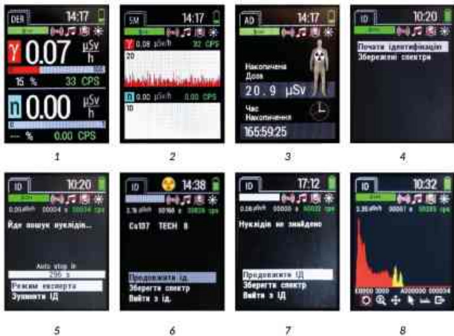
Рисунок 2.30 – Основні режими роботи дозиметра-радіометра пошукового MKS-11 «СПЕКТРА»: 1 – режим вимірювання та індикації ПАЕД по гамма- та нейтронному каналах; 2 – режим відображення гістограм інтенсивностей по гамма- та нейтронному каналах; 3 – режим вимірювання АЕД; 4 – вікно режиму ідентифікації радіонуклідів; 5 – процес пошуку нуклідів; 6 – приклад ідентифікації радіонукліда; 7 – повідомлення про відсутність ідентифікованих нуклідів; 8 – відображення амплітудного гамма-спектра
