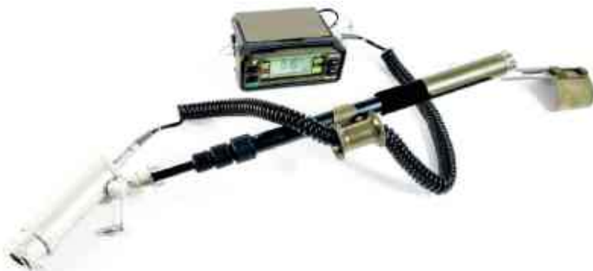
Рисунок 2.18 – Дозиметр-радіометр МКС-УМ із блоком детектування БДКС-01, кабелем до нього і телескопічною штангою
