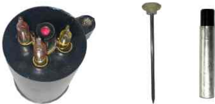
Рисунок 2.37 – Грілка з установленими ІТ-44, ІТ-45 і патроном грілки, а також пробійник грілки і патрон для грілки
