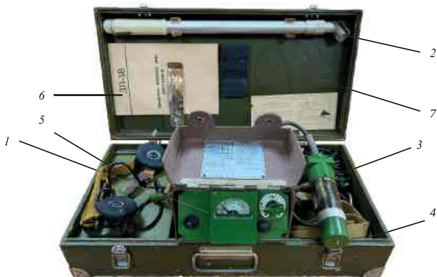
Рисунок 2.13 – Вимірювач потужності дози ДП-5В
