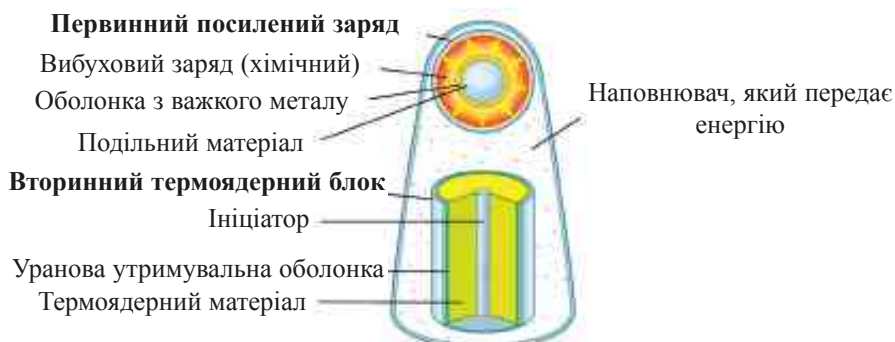
Рисунок 1.33 – Двоступенєва термоядерна схема, частина 1.
