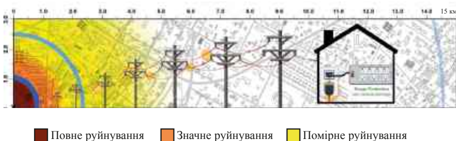
Рисунок 1.48 – Поширення ЕМІ від ядерного вибуху
