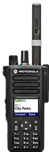
Рисунок 1.62 – Загальний вигляд і тактико-технічні характеристики портативної радіостанції Motorola Moto TRBO DP 4800 (4801)
