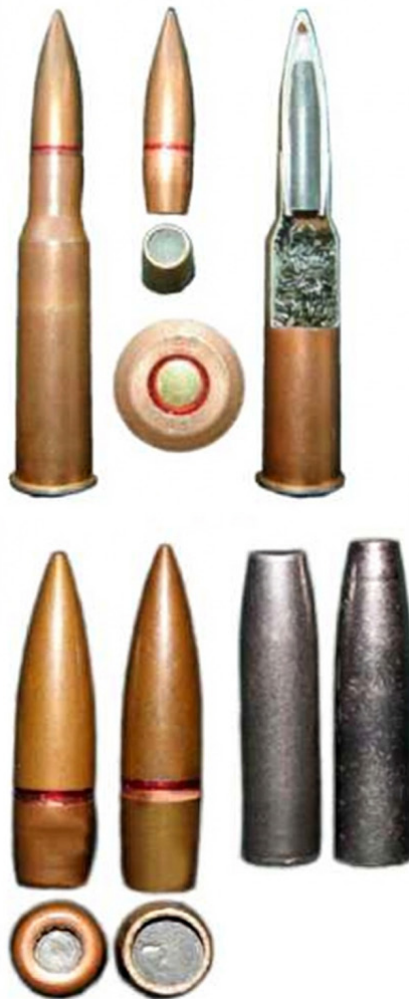
Рисунок 4.5 – Порівняння патронів: куля ЛПС та її осердя (ліворуч) та куля СТ-М2 зі сталевим осердям із термозміцненої сталі (праворуч)
