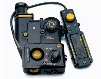
Рисунок 4.60 – ЛЦВ (лазерні цілевказівники)
