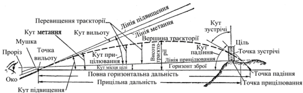
Рисунок 4.31 – Траєкторія та її складові
