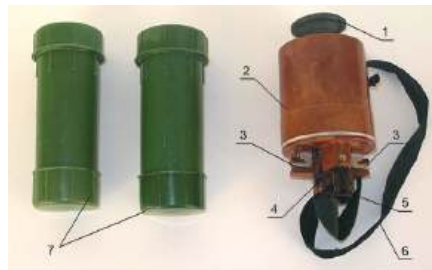
Рис. 4.32 Підривна машинка ПМ-4: 1 – штовхач; 2 – пластмасовий корпус; 3 – лінійний затискач; 4 – індикатор; 5 – ручка перемикача; 6 – стрічка для перенесення; 7 – провідові одноразові лінії
