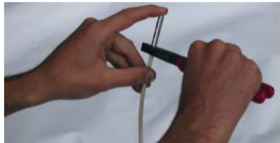
Рис. 4.21 Обтискання капсуля-детонатора на вогнепровідному шнурі
