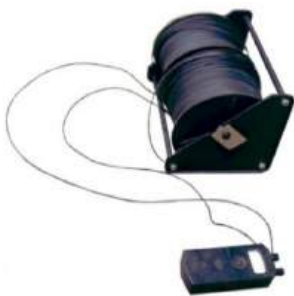
Рис. 4.28 Перевірка саперного дроту за допомогою малого омметра М-57
