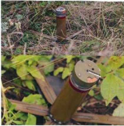
Рис. 5.35 Міна ПОМ-3, встановлена в ґрунті
