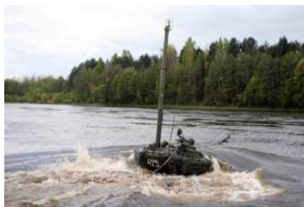
Рис. 6.14 Переправа танків під водою
