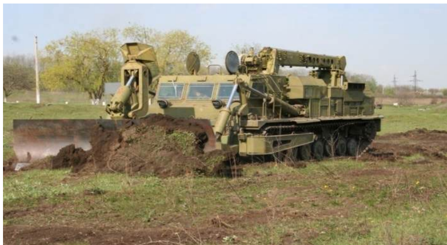
Рис. 7.10 Загальний вигляд БАТ-2
