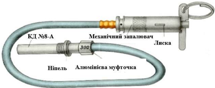
Рис. 4.25 Будова ЗТП з механічним спалахувачем
