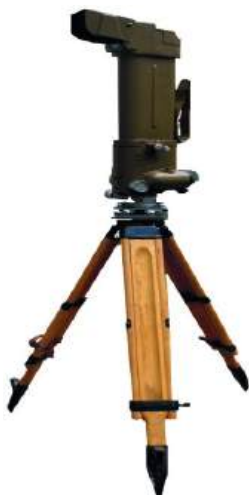
Рис. 3.12 Прилад далекого фотографування ПДФ
