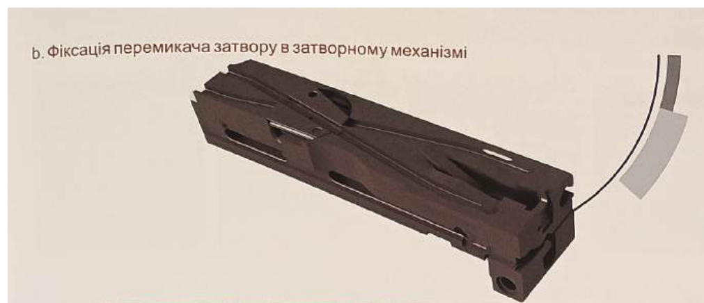
Рис. 6.160. Встановлення перемикача затвору в затворний механізм
