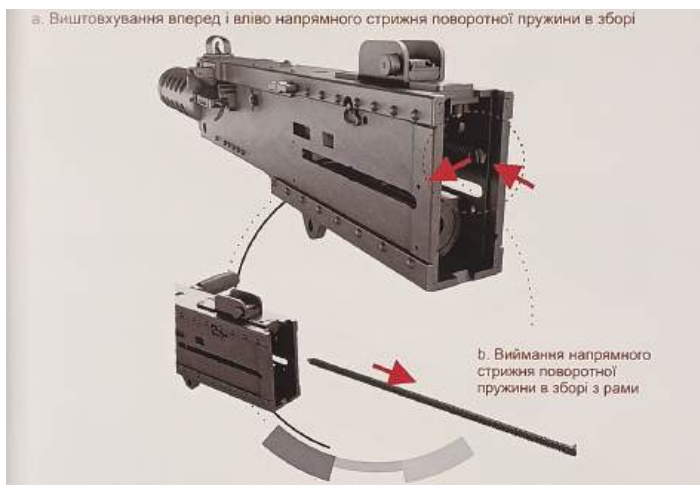
Рис. 6.136. Виймання напрямного стрижня поворотної пружини в зборі
