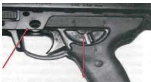
Рис. 5.12. Від'єднання спускового механізму
