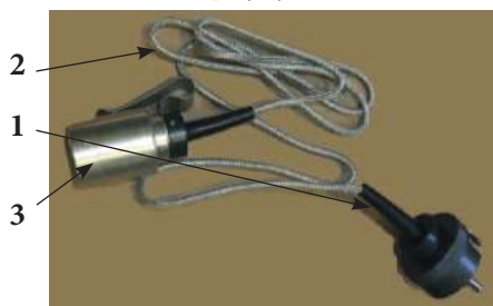
Рис. 6.51. будова зимової системи освітлення 1 – ковпачки; 2 – кабель; 3 – корпус.
