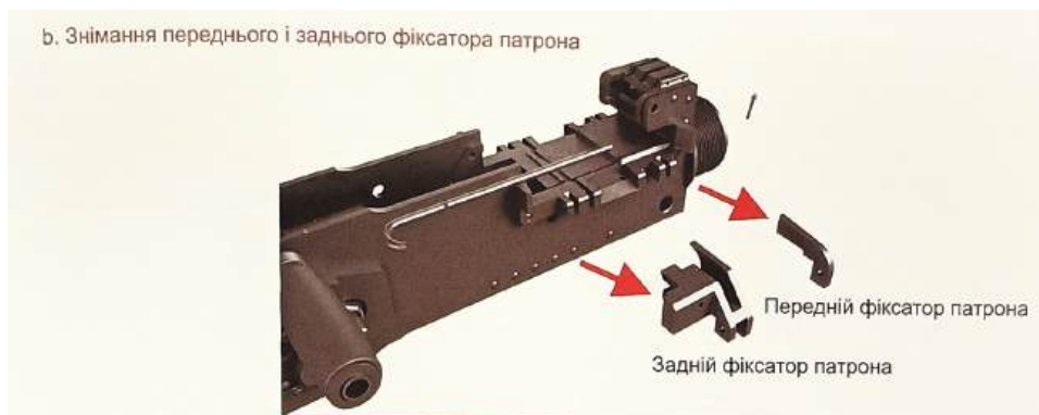
Рис. 6.147. Знімання переднього і заднього фіксатора патрона
