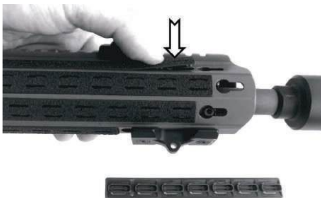
Рис. 4.61. Кріплення накладки на цівку з кріпленням типу кеймод (KeyMod)
