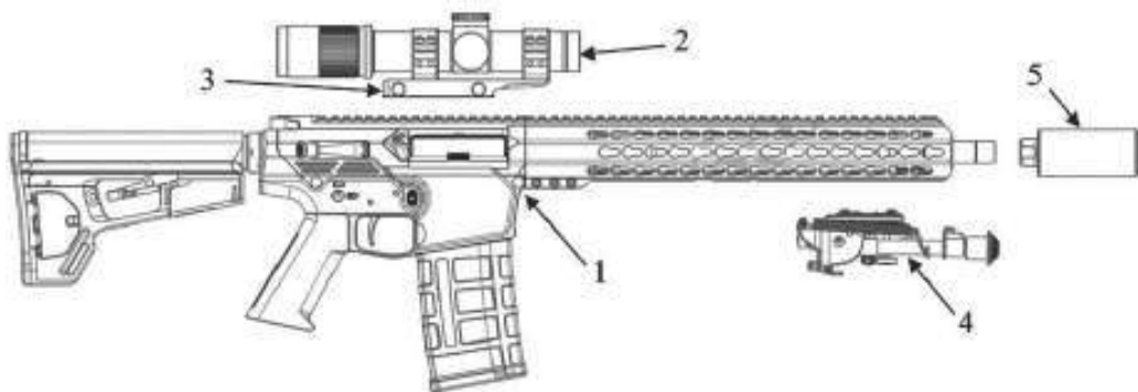
Рис. 4.46. Гвинтівка UAR-10M з аксесуарами 1 – гвинтівка в зборі; 2 – оптичний приціл; 3 – кронштейн (для кріплення оптичного прицілу); 4 – сошки; 5 – полум’ягасник
