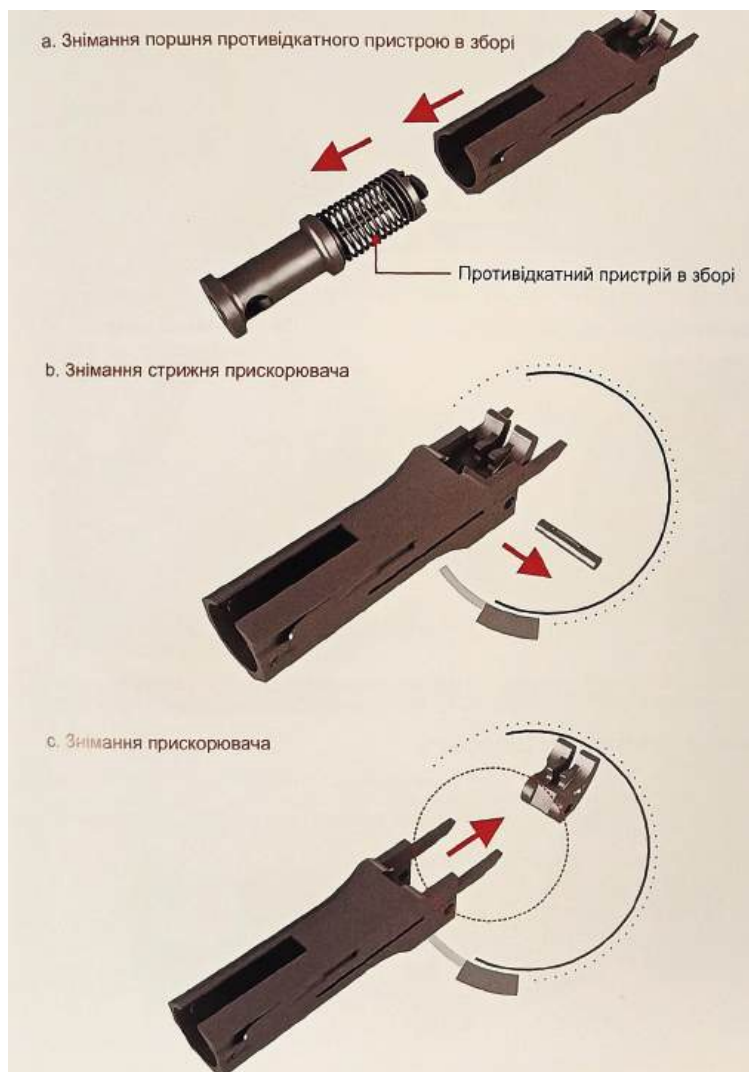
Рис. 6.145. Виймання поршня протівідкатного пристрою в зборі і прискорювача
