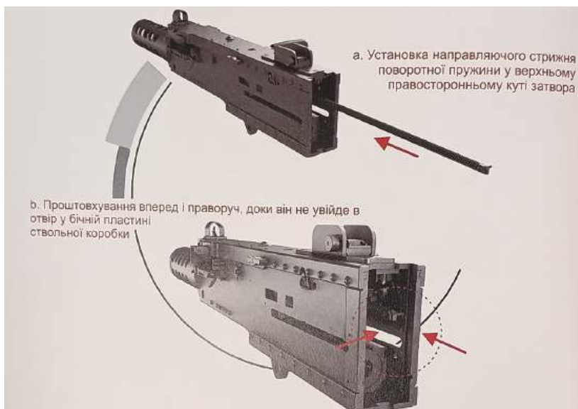
Рис. 6.163. Установка направляющего стрижня поворотной пружины
