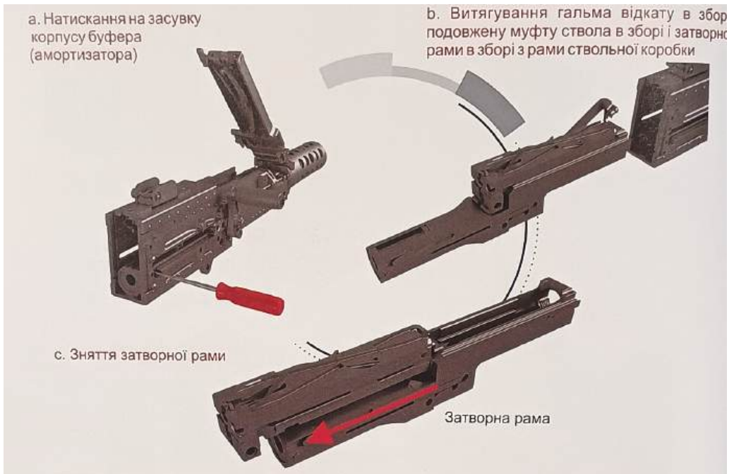
Рис. 6.138. Зняття затворної рами в зборі з рами ствольної коробки
