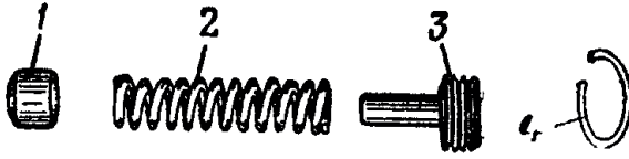
Рис. 6.90. Пружинний фіксатор: 1 – власне фіксатор; 2 – пружина; 3 – гвинт з направляючим стрижнем
