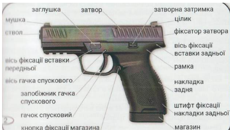
Рис.3.8. Загальний вигляд і будова зовні пістолета Форт-20
