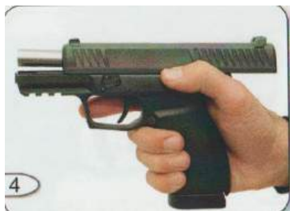
Рис. 3.10. Рух затвору пістолета Форт-20
