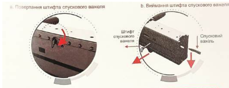
Рис. 6.148. Виймання штифта спускового важеля
