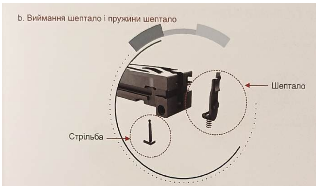
Рис. 6.142. Виймання повзуна шептало, шептало і пружини шептало
