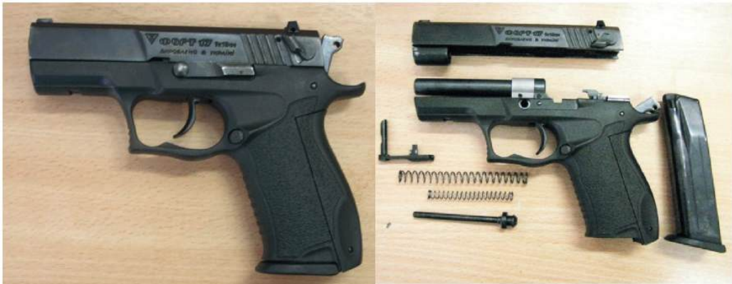
Рис. 3.5. Загальний вигляд і будова пістолета ФОРТ-17
