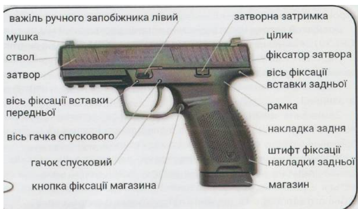
Рис.3.7. Загальний вигляд і будова зовні пістолета Форт-20
