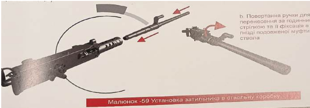
Рис. 6.165. Установка затильника в ствольну коробку
