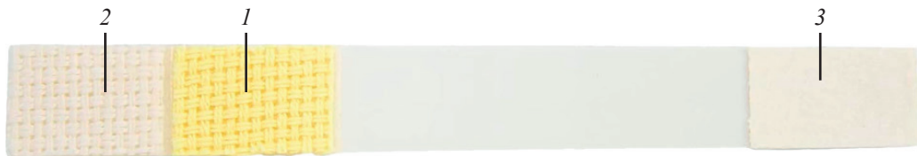
Рисунок 2.47 – Детекторна смужка типу ДЕТЕНІТ: 1 – жовтий еталонний шар; 2 – білий детекторний шар; 3 – білий індикаторний шар
