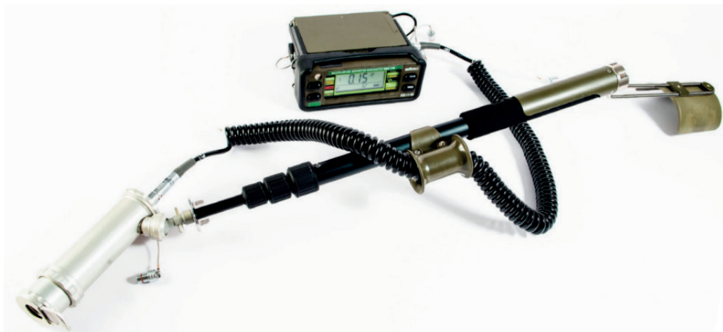
Рисунок 2.17 – Дозиметр-радіометр МКС-УМ із блоком детектування БДКС-01, кабелем до нього і телескопічною штангою
