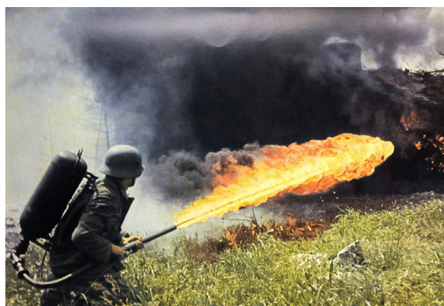
Рисунок 1.76 – Застосування вогнесумішей, що не згущуються, у ранцевих вогнеметах: a – німецький ранцевий вогнемет Flammenwerfer 35 (1940 роки, максимальна дальність пострілу 25 м); б – німецький вогнемет Flammenwerfer 41 (1944 р. під час придушення Варшавського повстання, максимальна дальність пострілу 32 м)
