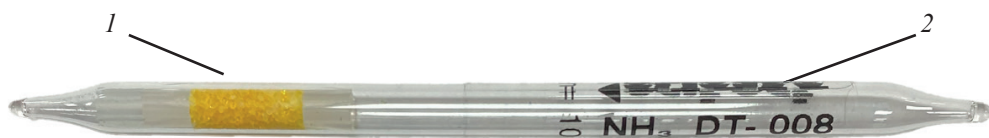
Рисунок 2.41 – Індикаторна трубка DT-008: 1 – індикаторний шар; 2 – маркування ІТ (NH 3 DT-008)
