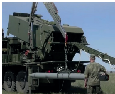
Рисунок 1.95 – ТОС-2: а – бойова машина; б – процес заряджання краноманіпулятором, установленим на бойовій машині
