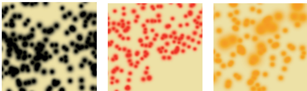
Рисунок 2.45 – Приклад зміни кольору індикаторного паперу CALID-3
