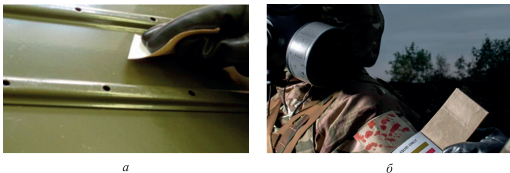
Рисунок 2.44 – CALID-3: а – підготовка поверхні; б – розміщення індикаторного паперу на одягу і порівняння з кольоровим еталоном
