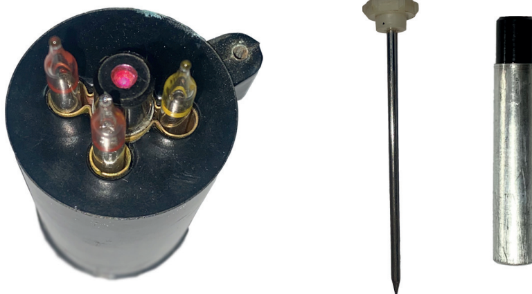
Рисунок 2.32 – Грілка з установленими ІТ-44, ІТ-45 і патроном грілки, а також пробійник грілки і патрон для грілки
