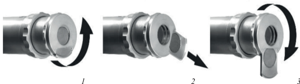
Рисунок 2.21 – Відкриття вікна бета-детектора БДКС-1: 1 – відпустити гайку, що фіксує шторку вікна бета-детектора; 2 – відкрити вікно бета-детектора; 3 – зафіксувати шторку вікна бета-детектора у відкритому стані
