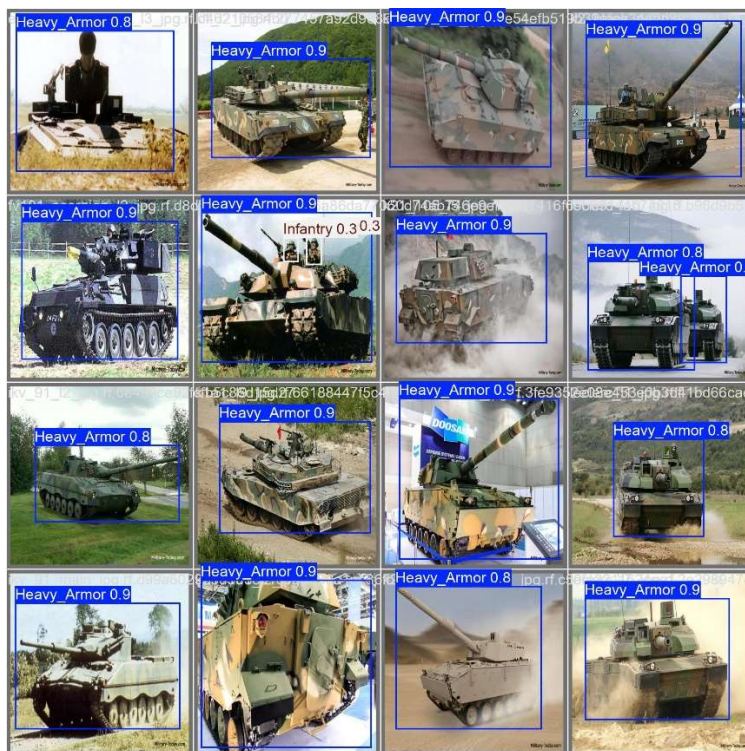
Рисунок 2 – Приклад роботи квантованої моделі YOLOv8n (INT8) з виявлення та класифікації цілі на тестовому зображенні
